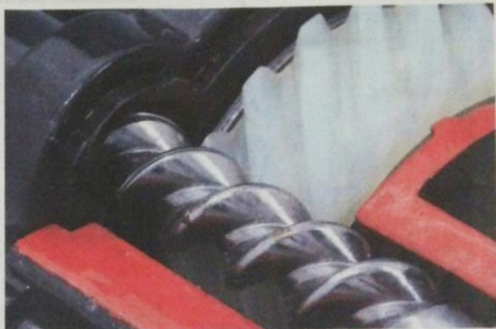
転造加工のブレークスルーで歯数2のはずば歯車を実現(アイシン精機)
